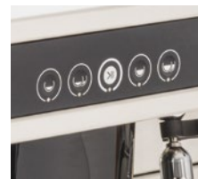
Pulsantiera a membrana effetto tattile con indicatori a LED
